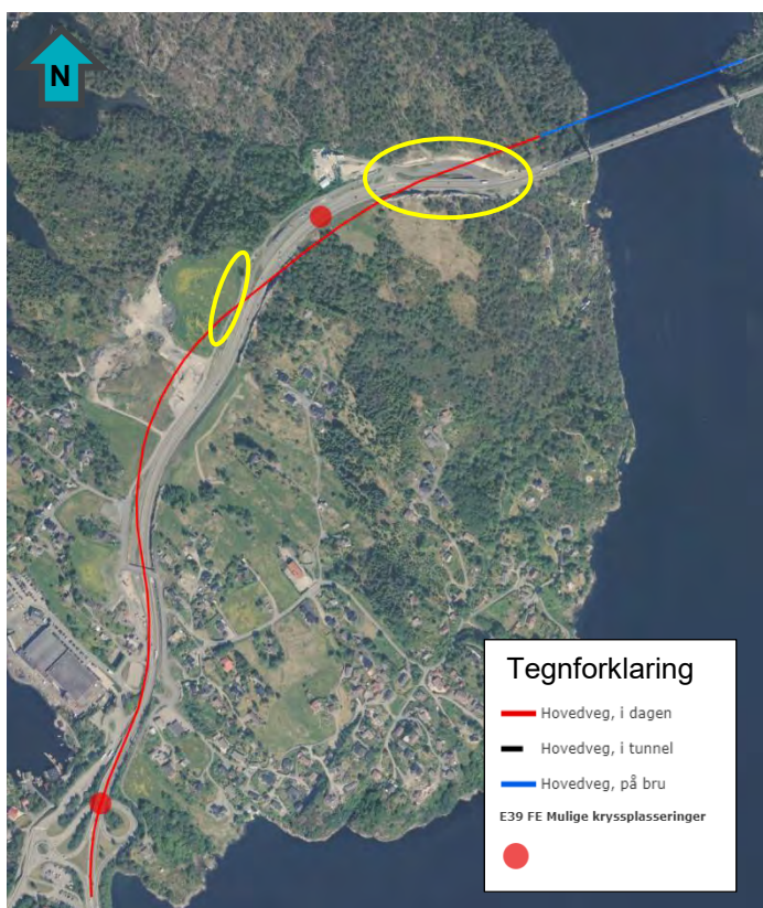
Figur 9: Flyfoto med vegkorridor for delområde Flatøy. Partier med bergskjæring langs eksisterende veg er markert med gul sirkel.
